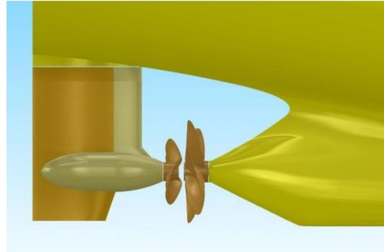
**Figure 3. Rudder-POD.**
